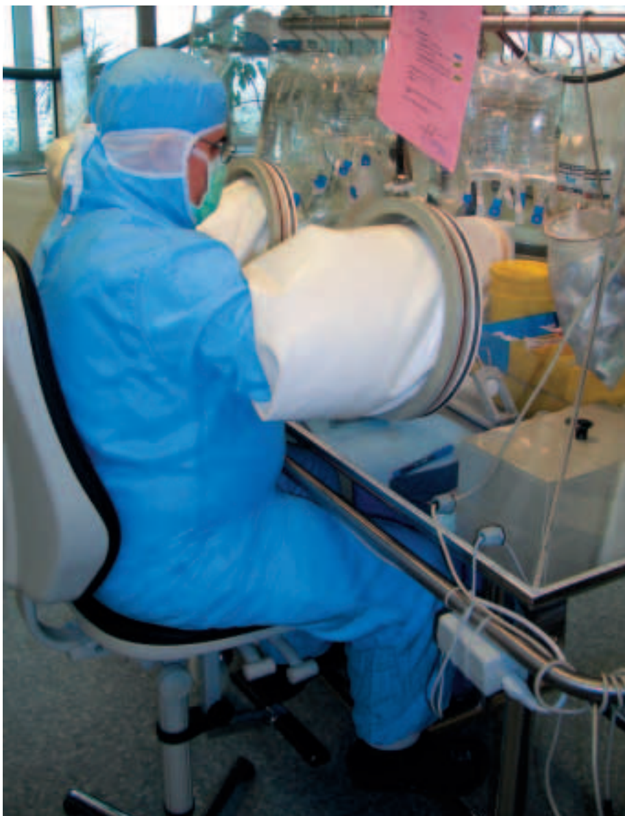
Abbildung 4 Isolator in einer Kranken- hausapotheke.
